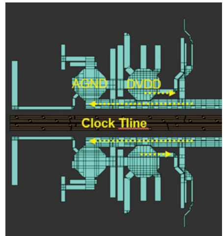
RaptorX可让NVIDIA提取长时钟布线，以及附带大量端口的多路径构成的供电网络
