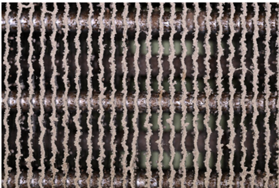
脏冷凝器上的非球形灰尘颗粒与纤维的宏观视图
