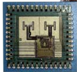
低成本的8X8mm 2 雷达前端将应用于最终产品。
