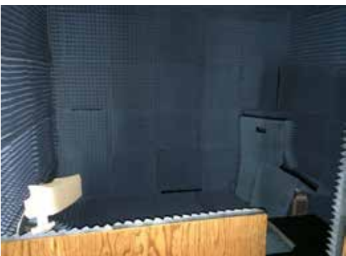
用于测试格栅材料的消声室
