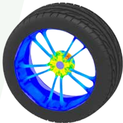
▲ 汽车轮缘连续螺栓预张力仿真得出的等效应力 图片由SVS FEM提供。
