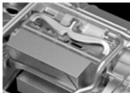
▲ 使用ANSYS CFD仿真逆变器冷却系统
