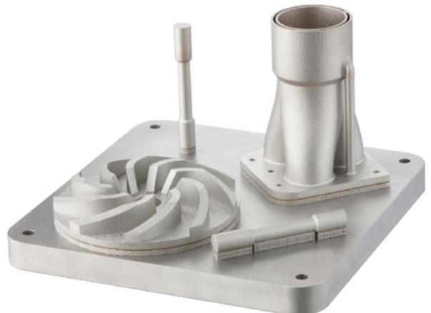
本图所示的是带有测试件和增材制造部件的基板，这些测试件可用于结构测试
