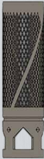
经过重新设计将支架与滤网合并的部件的CAD模型
