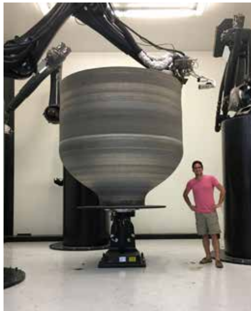
Relativity公司的Stargate是全球最大的3D打印机。
