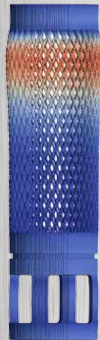
原始设计方案的ANSYS增材制造仿真结果与实际部件所示的变形匹配。
