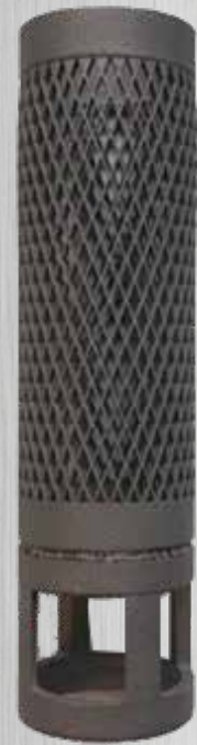
采用增材制造技术首次尝试制作部件产生了明显变形。
