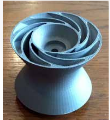
ANSYS Additive Print已经确认小型燃气轮机的部件无需额外支架。制成的产品证实该部件正确无误。
