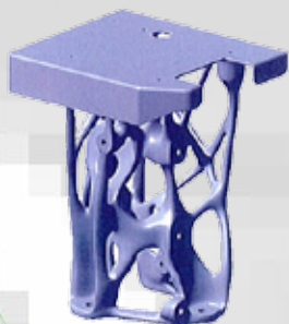
太阳组件传感器支架的CAD模型
