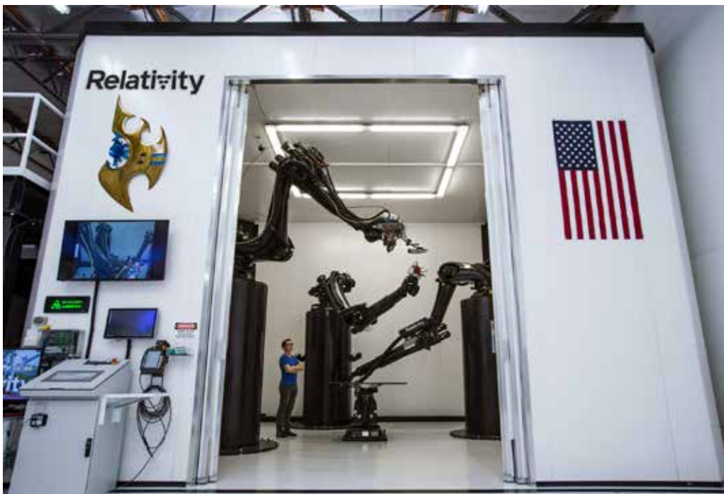
高15英尺，直径9英尺，Relativity公司的Stargate是全球最大的3D打印机。该初创公司目前采用ANSYS Additive Suite优化打印机的性能。
