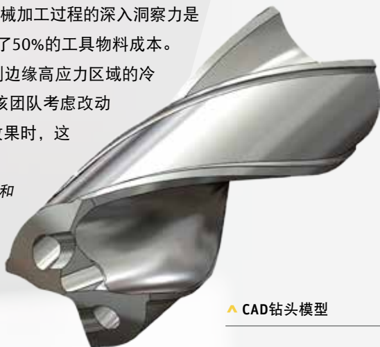
▲ 切削边缘的特写视图，包含固态工具域、流体域和因科内尔718号合金固态工件域
