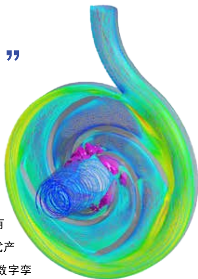
▲ 3D仿真模型显示，空化（即图中的紫色气泡）是由阀门故障所导致的，它也是导致振动问题的原因。
