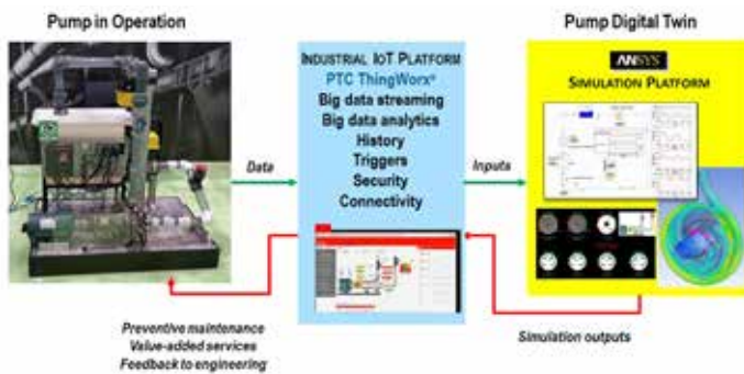
▲使用ThingWorx将实际的泵与其数字孪生体相连接。
