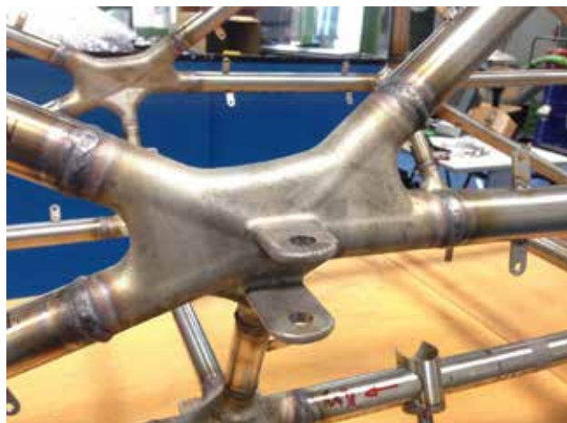
显示带一体化硬点连接器的四向接头的装配车架特写
