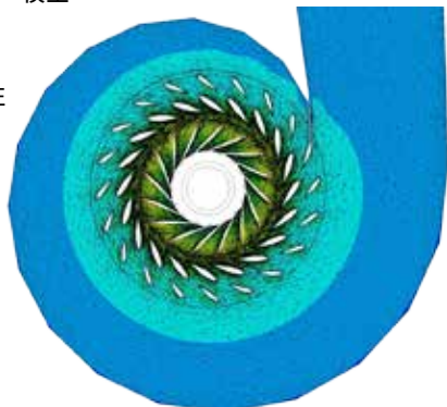
法氏涡轮机固定导流叶片及转轮叶片的速度仿真
