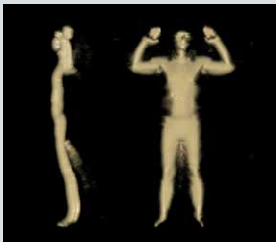
使用5GHz带宽和60度波束宽度时显示了降低深度分辨率对图像质量的影响。
