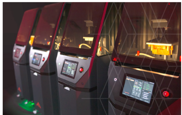
通过使用磁性材料涂层纤维，FLUX ONE 3D打印机可以选择性地校准纤维以强化部件
